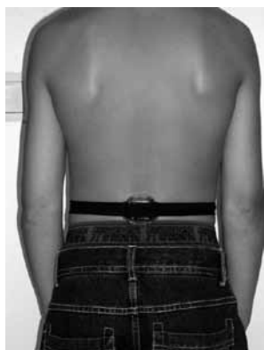
Figur 8.1. Eksempel på akselerometer og hvordan det festes på kroppen.
